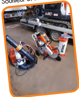
Souffleur et scie à béton
